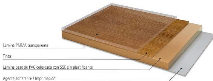
RENOLIT EXOFOL FX es extremadamente resistente a la intemperie, a los productos químicos y a los rayos UV. Gracias a los plásticos de alto rendimiento, el nivel de brillo permanece casi sin cambios durante toda la vida útil. Su baja tensión superficial hace que la lámina sea resistente a las manchas y fácil de limpiar. El efecto "easy to clean" de RENOLIT EXOFOL FX abre nuevos campos de aplicación para los elementos de construcción.
